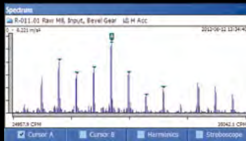
Symptôme d'engrènement avec bandes latérales
